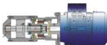
MINEX®-S для герметизации гомогенизаторов тяжёлых нефтепродуктов для морского применения
